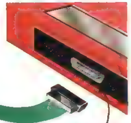
La entrada de una impresora Centronics está curvada por lo que no podrás conectar el cable al revés.
